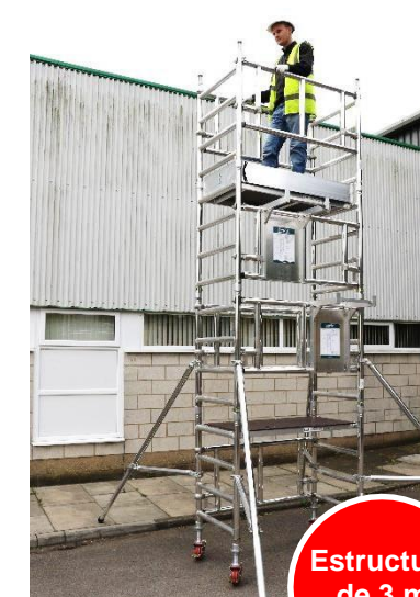
30. Acceda a la plataforma utilizando la trampilla y despliegue el rodapié.
