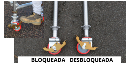
3. Bloquee los frenos y deje una rosca de 3" desde parte inferior de la rueda para nivelar.
